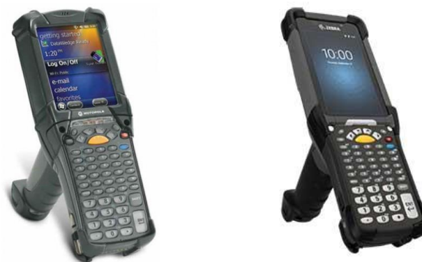
Slika 21. RF uređaji koji se koriste prilikom skeniranja i pregledavanja robe (uređaj lijevo Motorola MC9200, uređaj desno MC9300)
