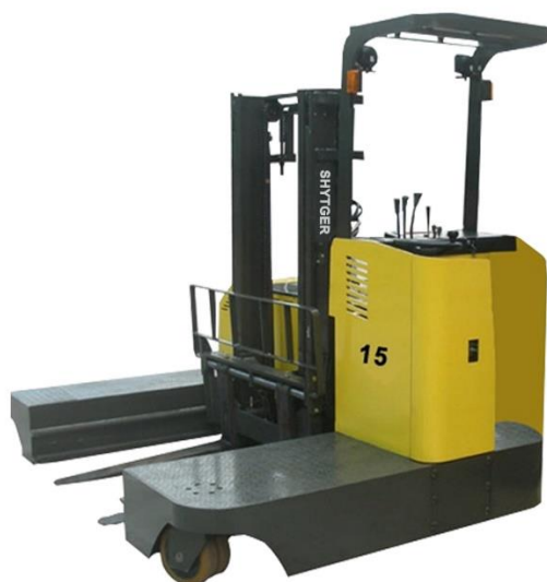
Slika 9. Prikaz bočnog viličara
