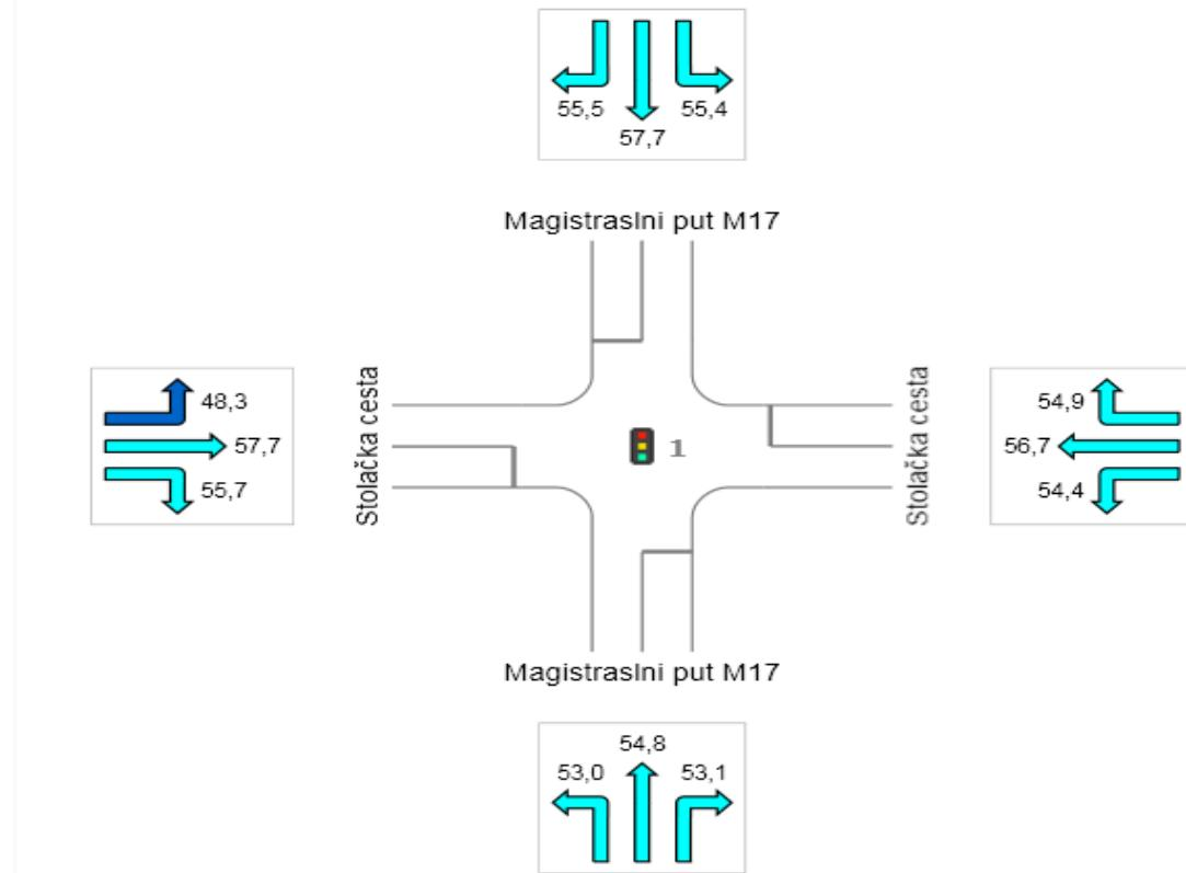
Slika 29. Brzine kretanja vozila na semaforiziranom raskrižju (km/h)
