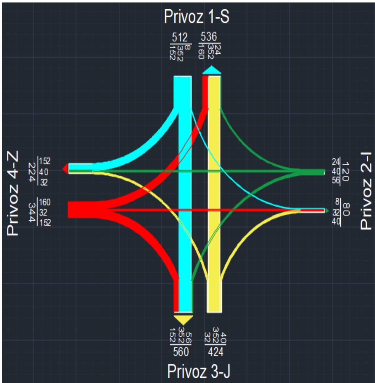
Slika 8. Opterećenje u jutarnjem vršnom satu
