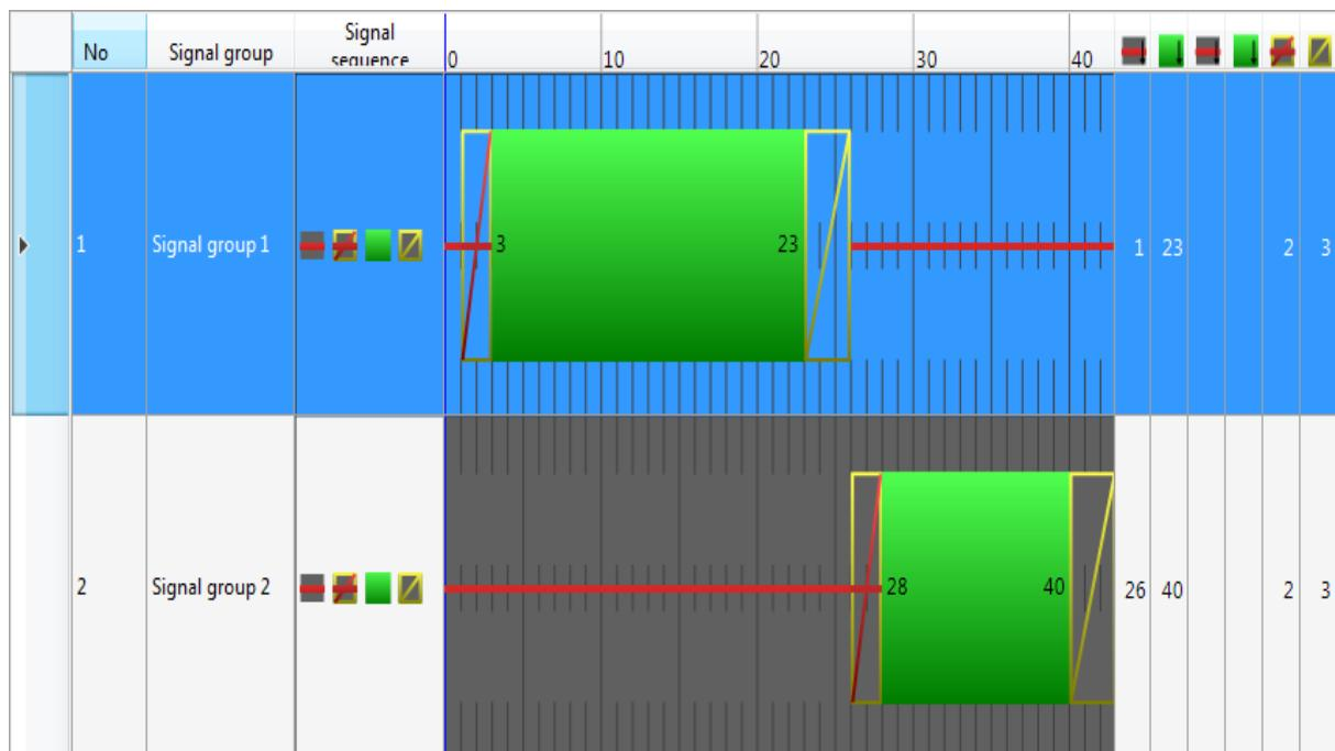
Slika 27. Prikaz signalnog plana semaforiziranog varijantnog rješenja
