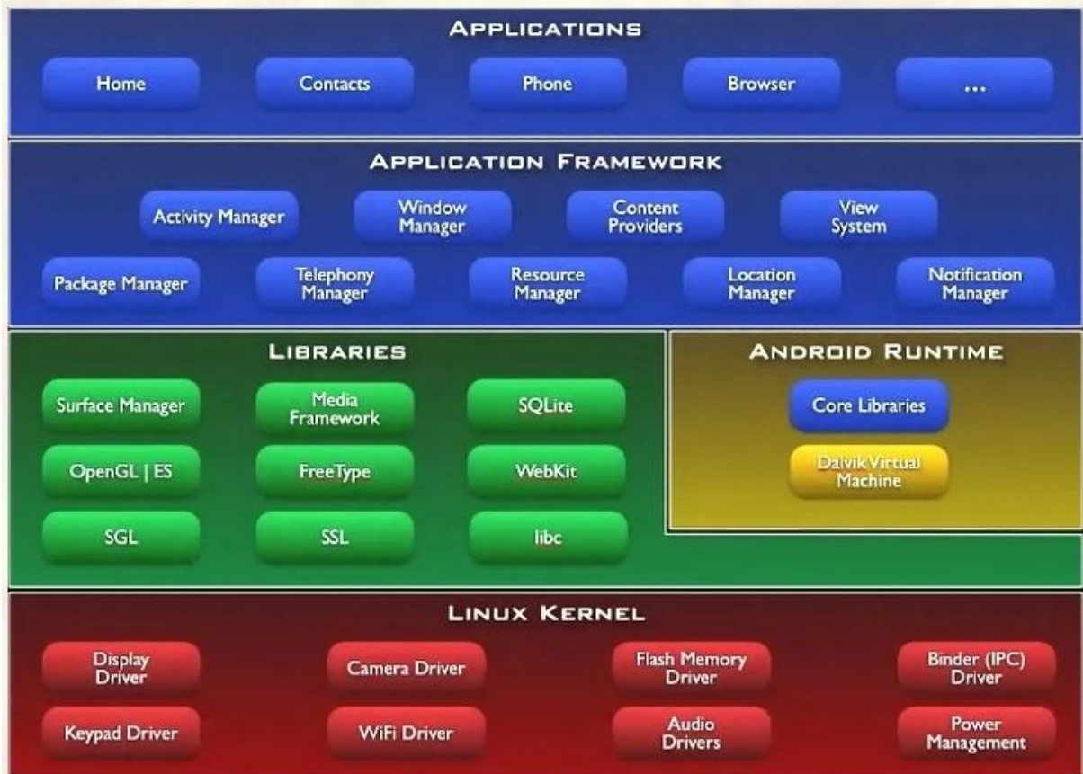
Slika 1: Arhitektura Android operacijskog sustava
