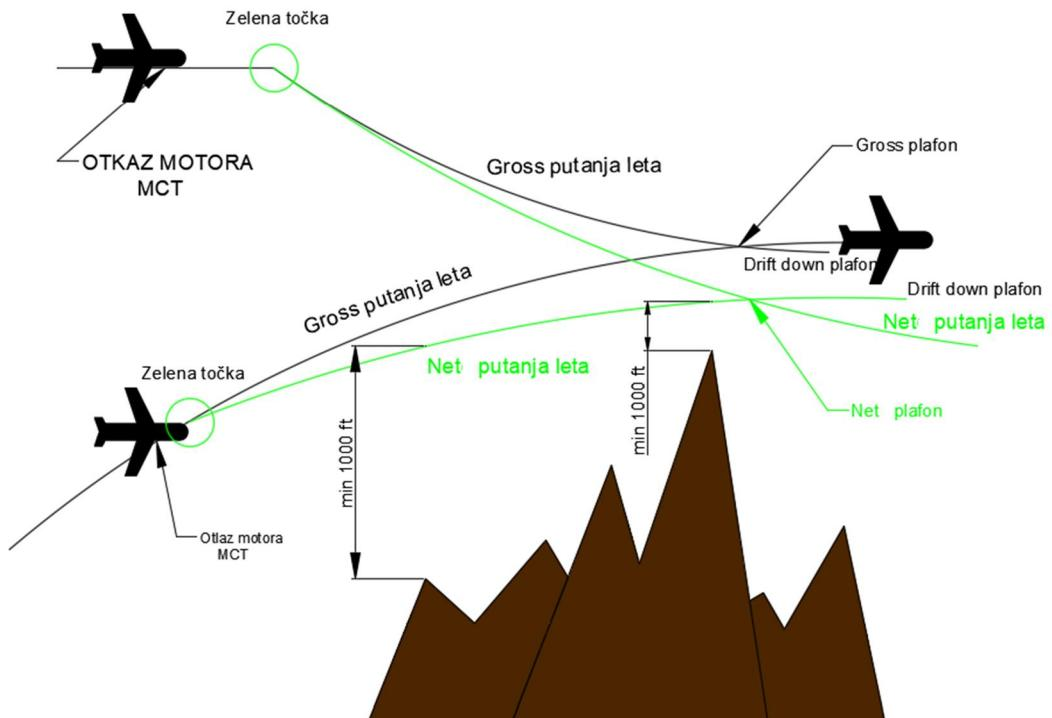
Slika 8. Vertikalno nadvišavanje za 1000 ft-a
