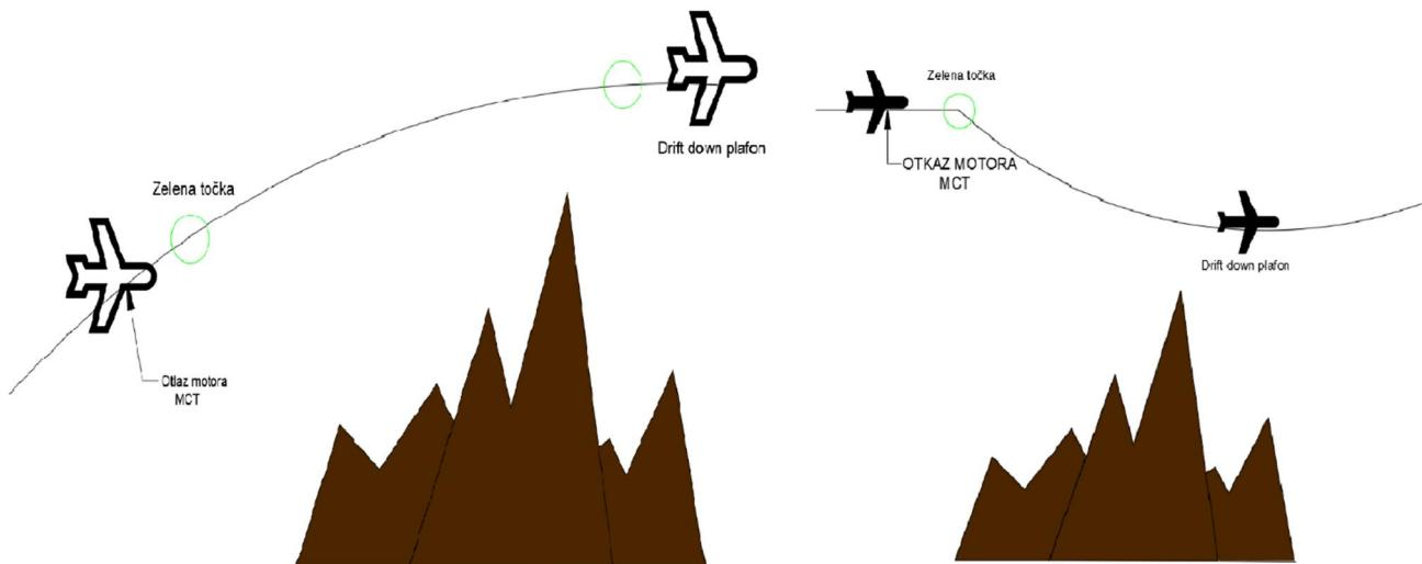
Slika 6. Drift down procedura (penjanje i spuštanje)
