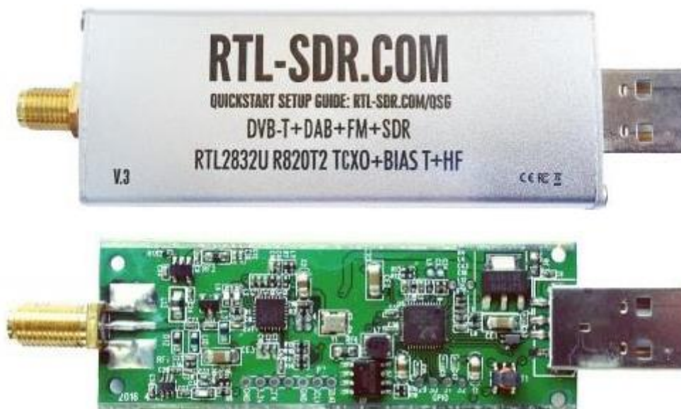
Slika 14: RTL-SDR radioprijamnik unutar kućišta (gore) i bez kućišta (dolje) [16]
