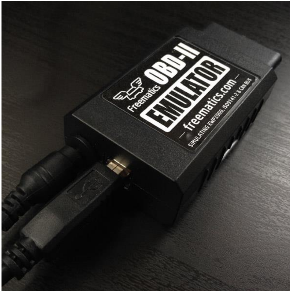
Slika 7. Prikaz Freematics OBD-II emulatora
