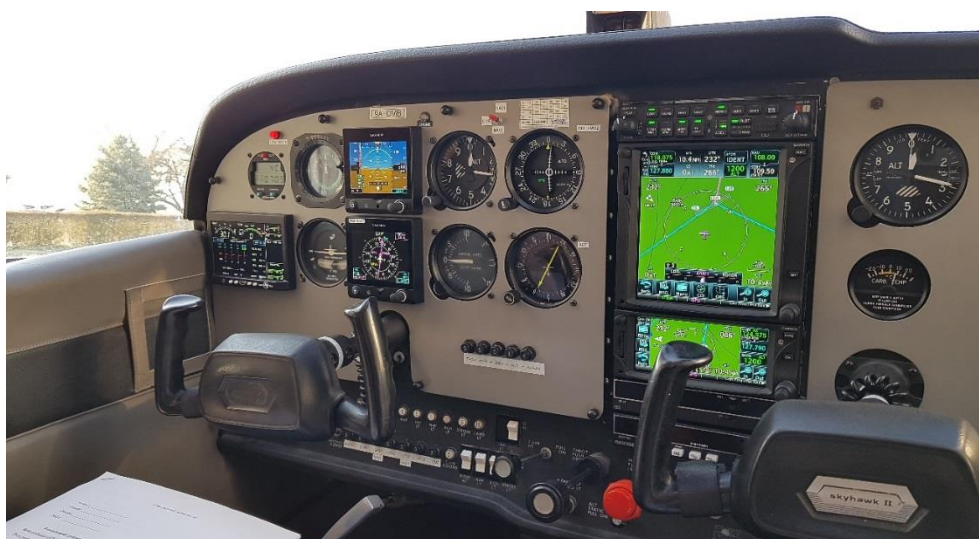
Slika 4. Izgled instrument ploče nakon modifikacije zrakoplova 9A-DMB
