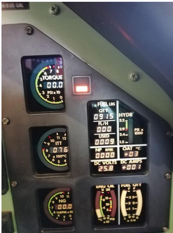
Slika 11. Lampica svijetli na +3 °C
