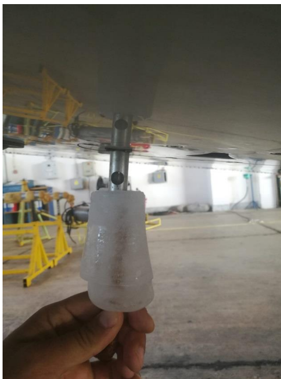
Slika 8. Izlaganje senzora ledu
