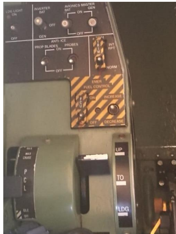
Slika 10. Prekidači sustava za sprječavanje zaleđivanja
