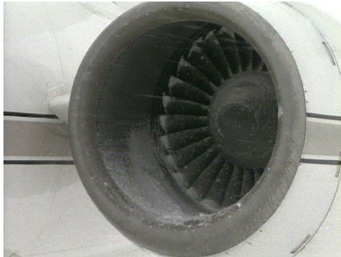
Slika 4. Pojava leda na motoru pri niskim temperaturama [10]
