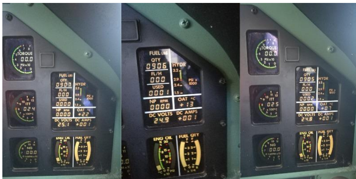
Slika 9. Opadanje temperature na prikazniku
