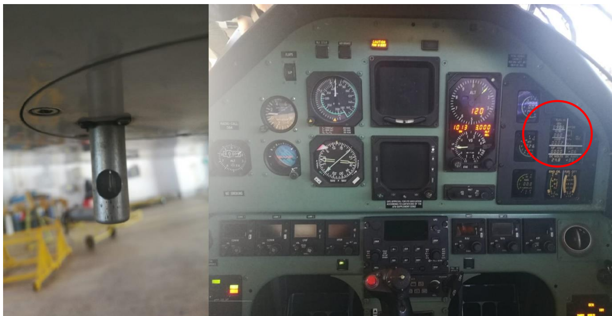
Slika 7. Lijevo: OAT senzor; Desno: Označen OAT prikaznik i indikator (lampica)
