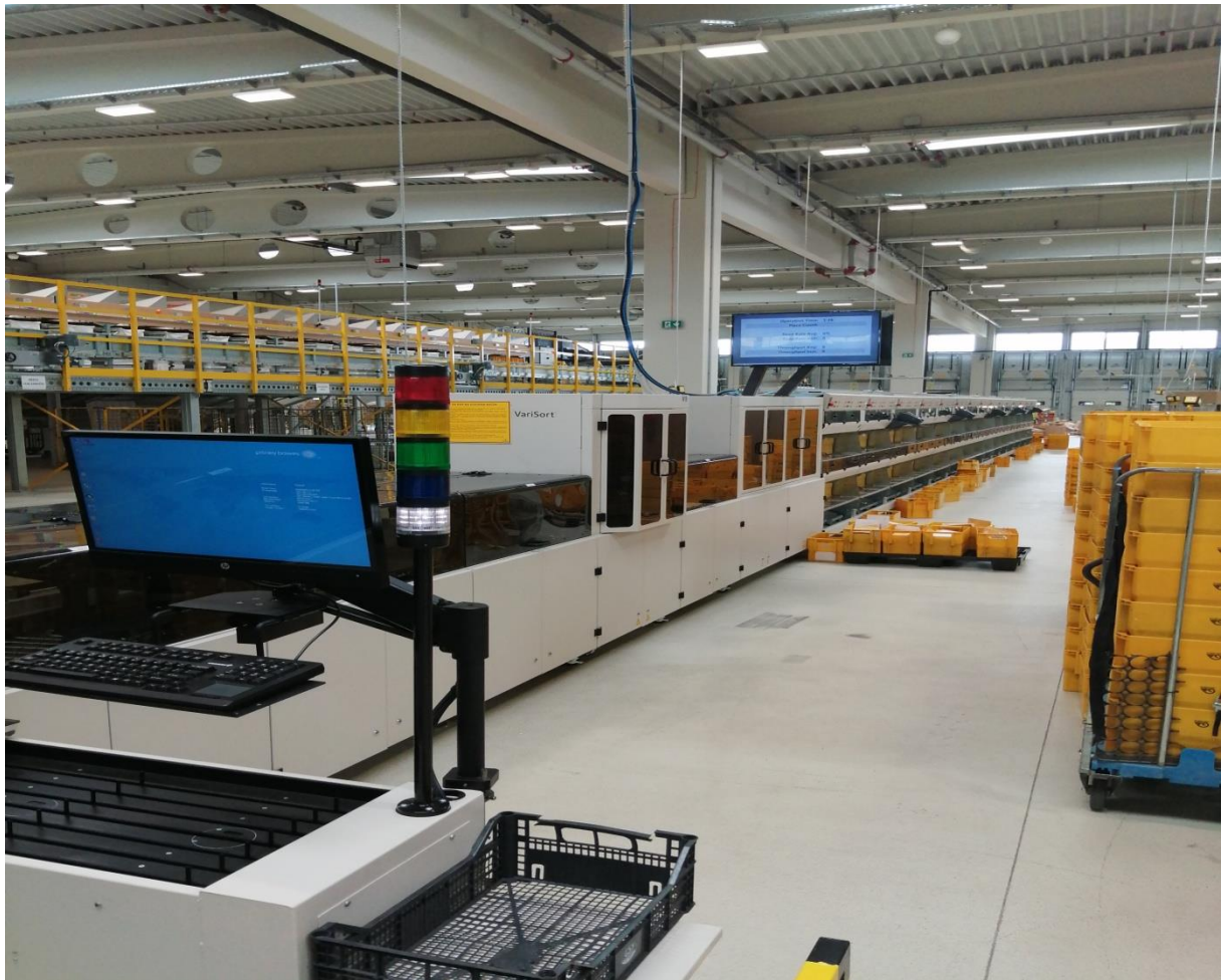
Slika 8: Sortiranje pošiljaka VariSort strojem
