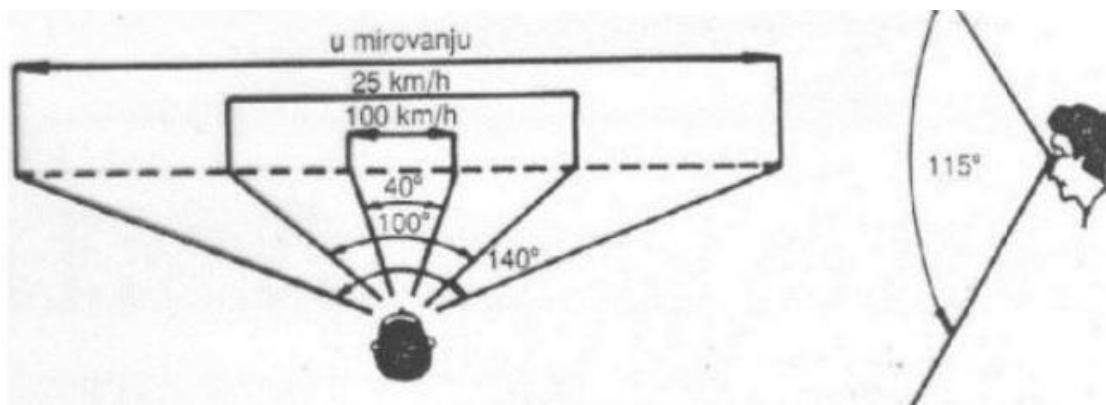
Slika 1. Prikaz horizontalnog i vertikalnog vidnog polja vozača
