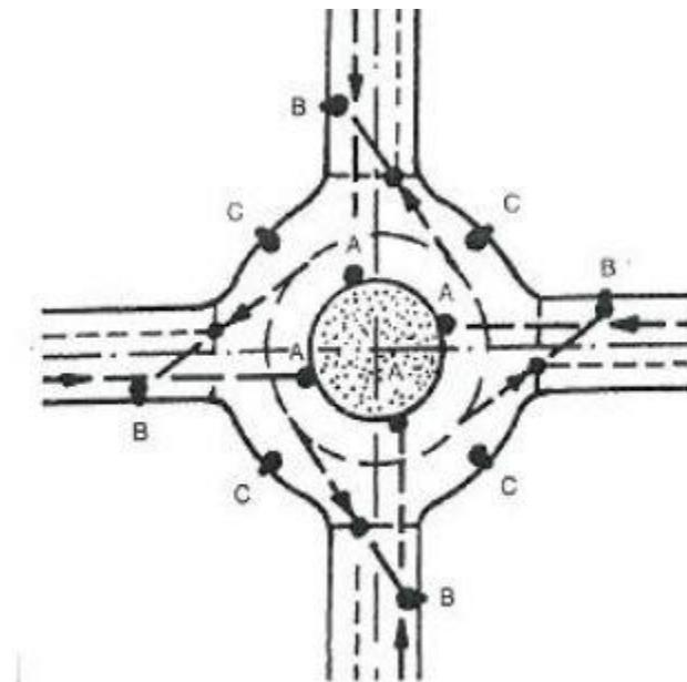
Slika 4. Rasvjetljivanje kružnog toka
