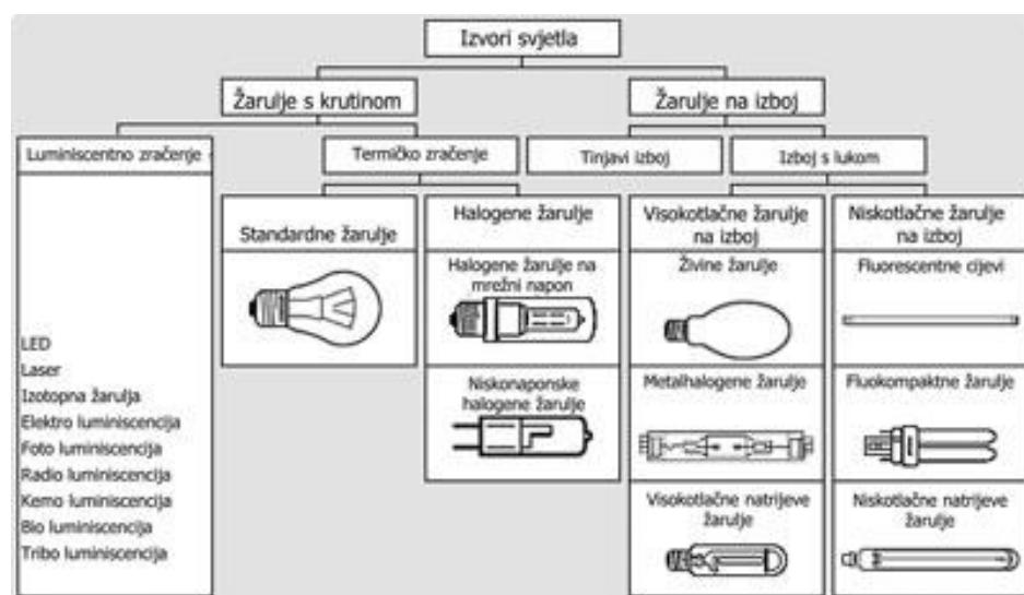
Slika 7. Podjela svjetla prema načinu generiranja
