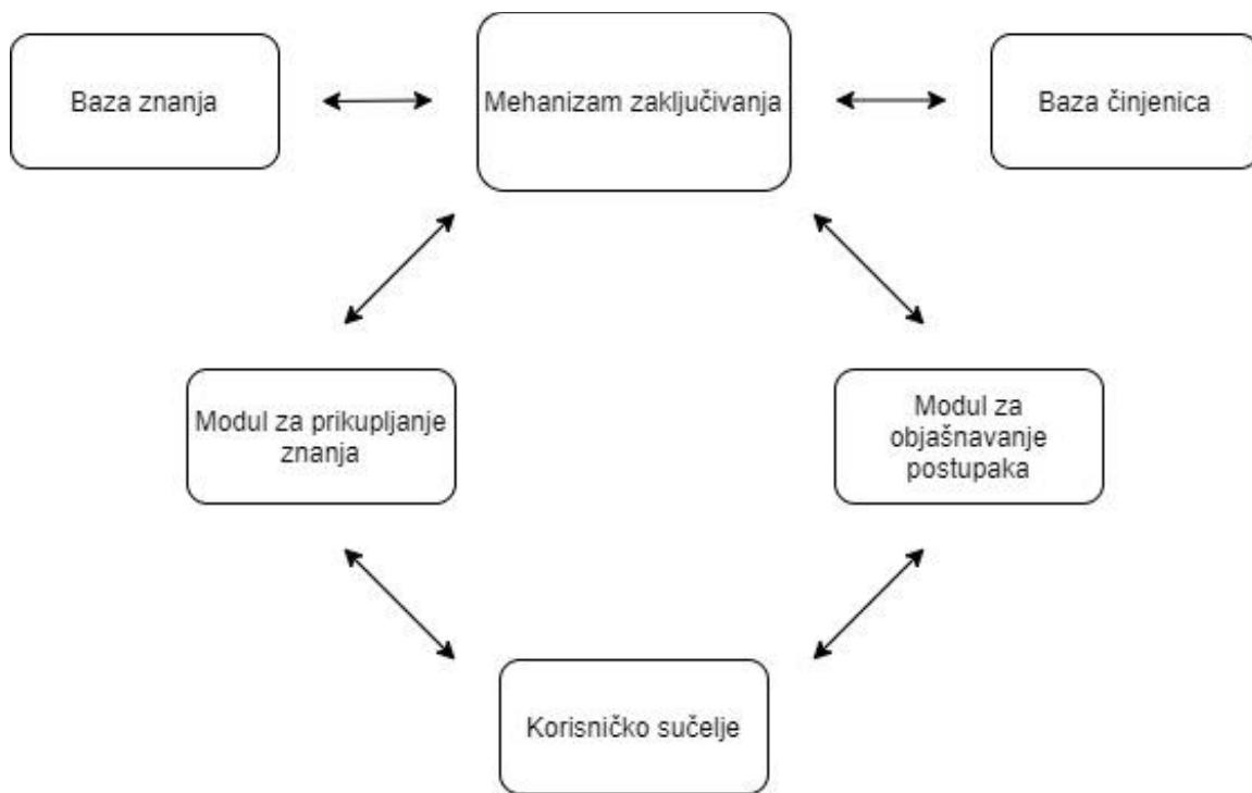
Slika 5. elementi eksperternog sustava [4]
