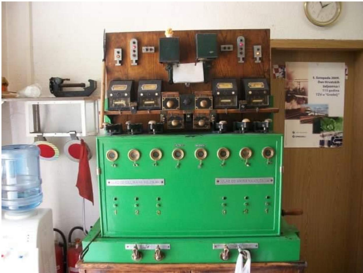
Slika 1. Uređaj za postavljanje puta s mehanički postavljanjem elemenata
