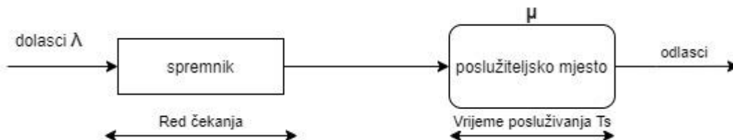
Slika 1. Prikaz jednposlužiteljskog podvorbenog sustava Izvor: [3]
