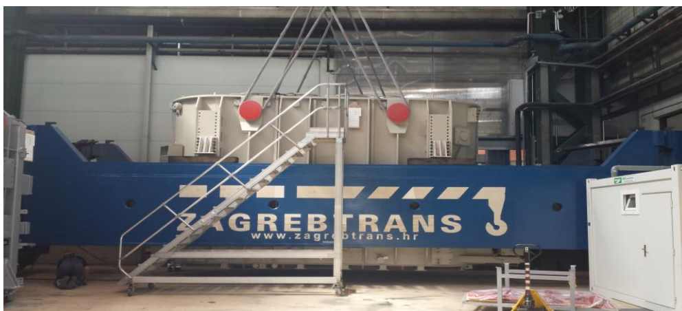
Slika 23. Ukrcaj transformatora Izvor: poduzeće ZAGREBTRANS
