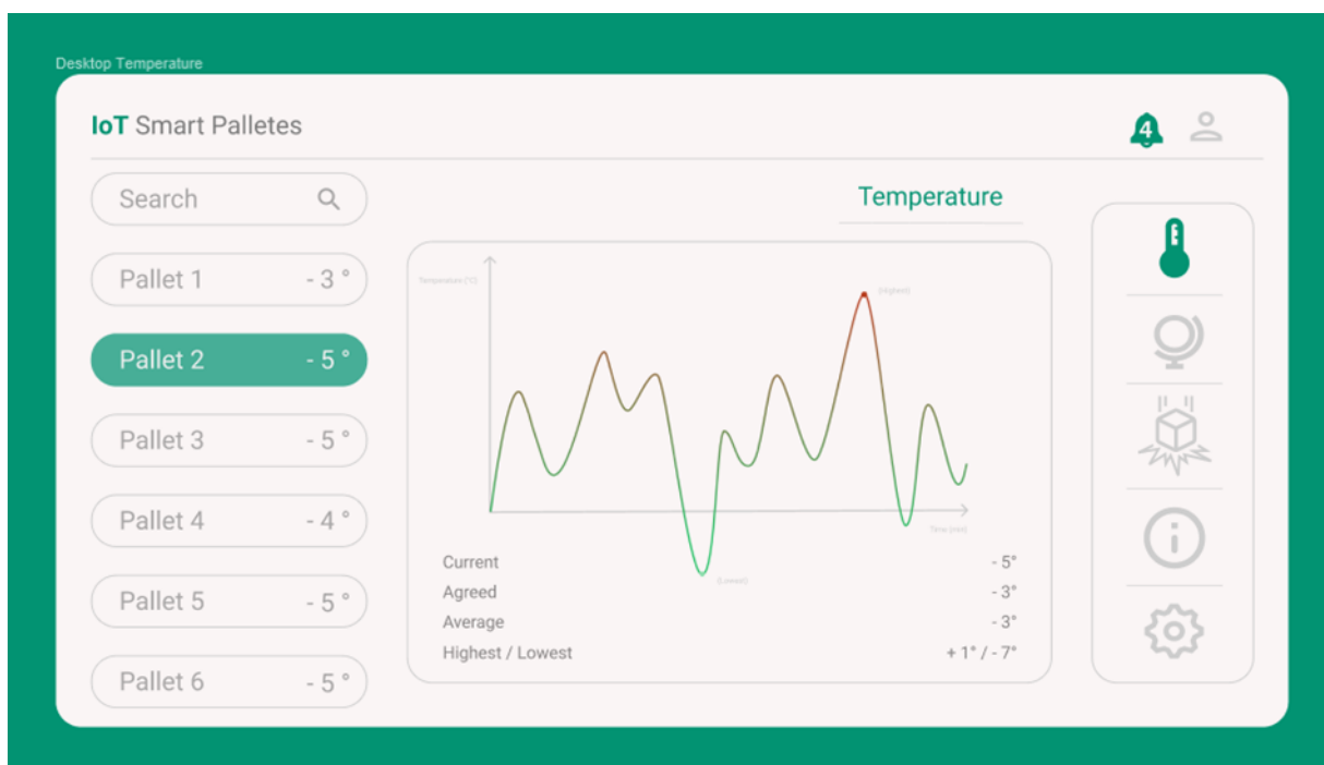
Slika 22. Prikaz sučelja desktop aplikacije SPIoT platforme-stavak „Temperatura“
