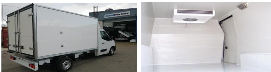
Slika 8 Vozilo s rashladnim uređajem (hladnjača) te unutrašnji prikaz vozila
