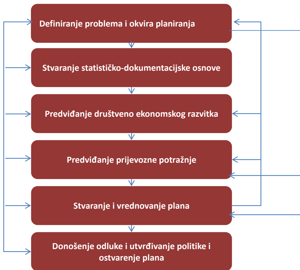
Slika 1. Opći slijed postupka prostorno-prometnog planiranja, [1]
