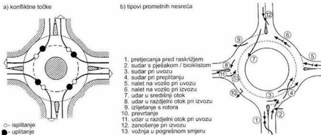
Slika 10. Konfliktne točke i tipične nesreće u dvotračnom raskrižju s kružnim tokom, [4]
