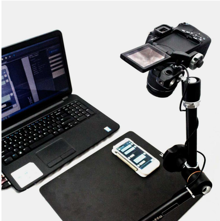
Slika 2. EDEC Eclipse alat za provođenje ručne ekstrakcije, [6]
