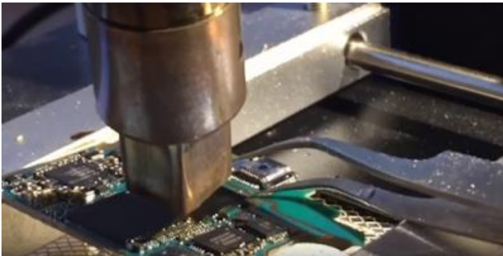
Slika 5. Odvajanje memorijskog čipa, [22].
