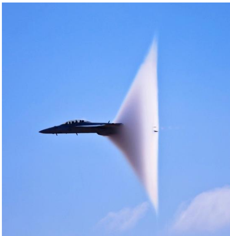
Slika 13. Pojava bijelog oblaka prilikom probijanja zvučnog zida
