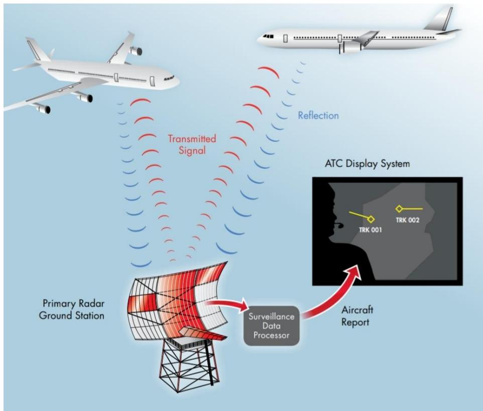
**Slika 1.** Primarni radar. [3]
