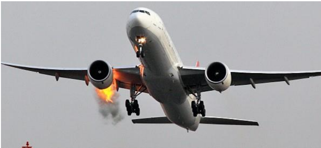
Slika 10 Kvar na motoru zrakoplova
