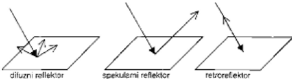
*Slika 2: Vrste površina prema načinu reflektiranja svjetla*
