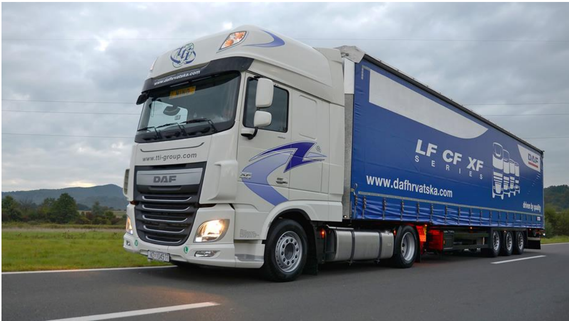
Slika 5. Tegljač s dvije osovine i poluprikolicom s tri osovine Izvor: https://tti-group.com/vozni-park/ [pristupljeno: svibanj 2020.]
