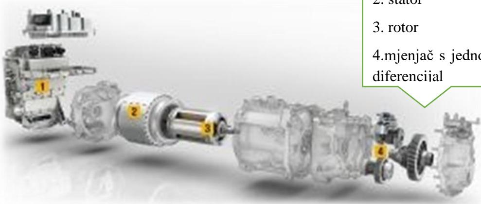
**Slika 4.** Pogonski sklop Renault Zaea, [2]
