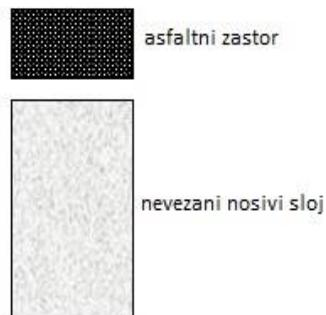
Slika 6. Nosivi sloj od nevezanog kamenog agregata
