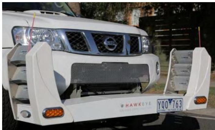
Slika 17. H2000 ACD uređaj za detektiranje pukotina
