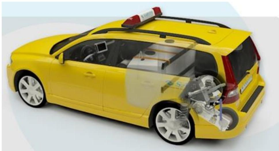
Slika 13. SARSYS Volvo friction tester (SVFT) vozilo
