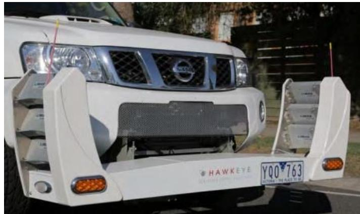
Slika 17. H2000 ACD uređaj za detektiranje pukotina
