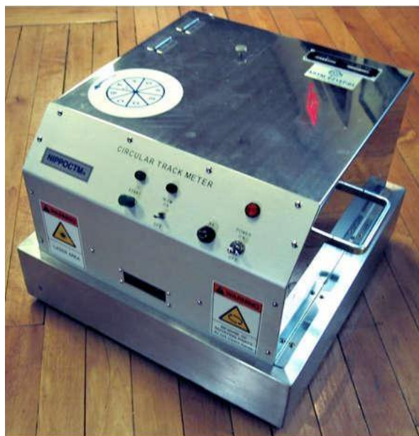
Slika 22. Circular Texture Meter
