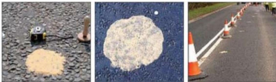
Slika 20. Određivanje dubine teksture pjeskarenjem
