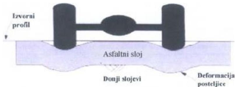
Slika 10. Kolotrazi nastali zbog deformacije slojeva ispod kolničke konstrukcije
