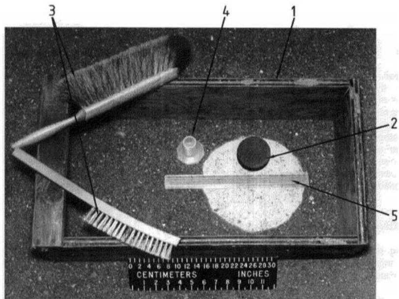
Slika 19. Aparatura za mjerjenje dubine makroteksture kolnika volumetrijskim postupkom
