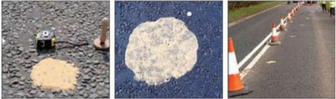
Slika 20. Određivanje dubine teksture pjeskarenjem
