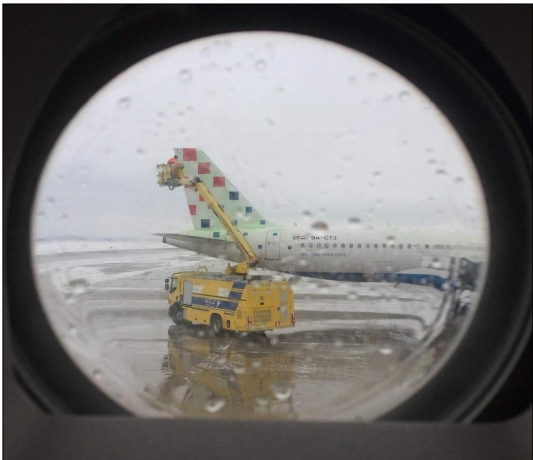
Slika 6. Odleđivanje zrakoplova kemikalijom Type 4 [Izvor:autor]
