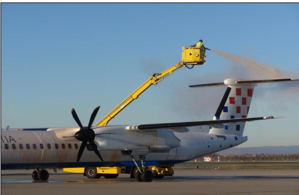
Slika 5. Odleđivanje repnih površina kemikalijom Type 1[8]
