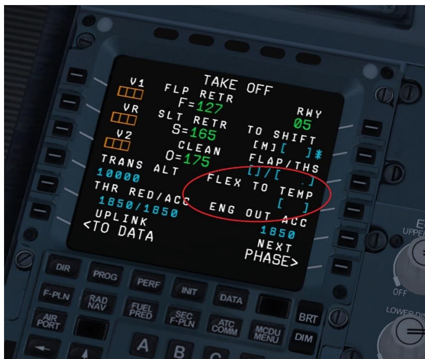
Slika 12. Prikaz mjesta unosa T_{FLEX} u MCDU na zrakoplovu Airbus A320
