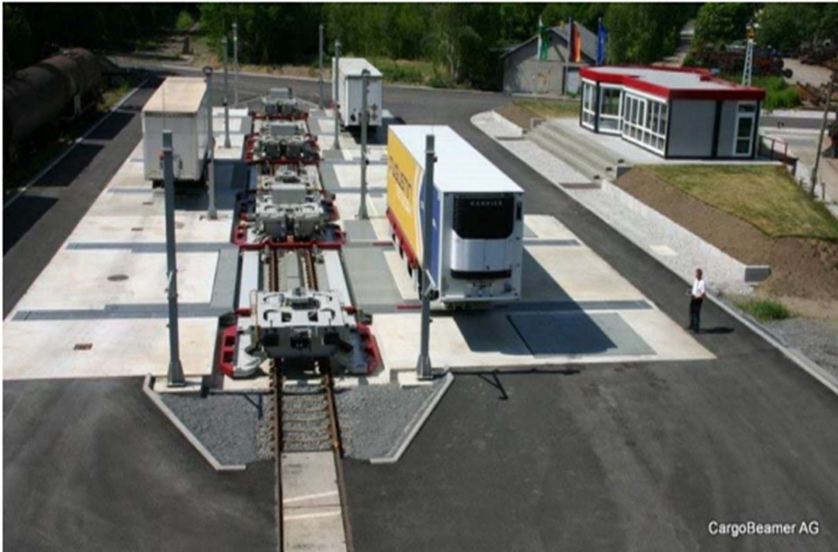
Slika 6. Prikaz CargoBeamer paralelnog utovara i istovara
