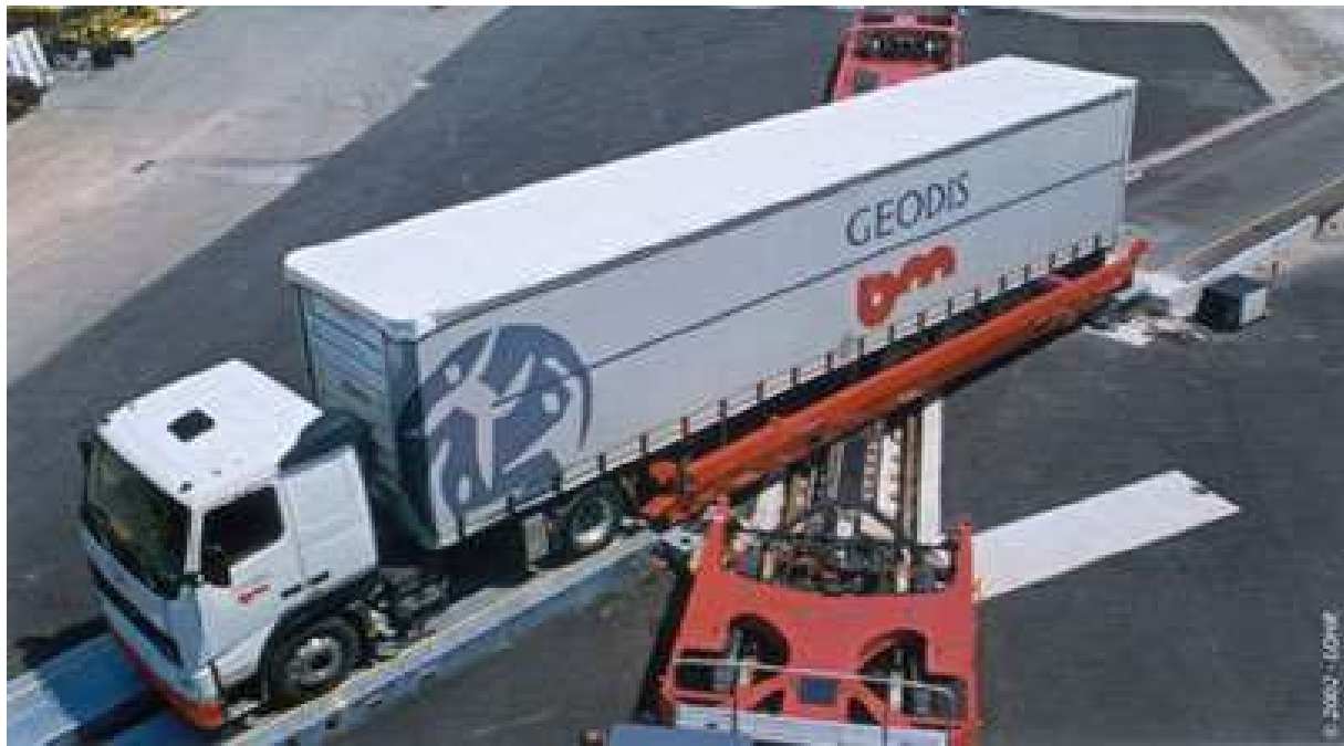
Slika 7. Bočni ukraj pomoću Modalohr tehnologije
