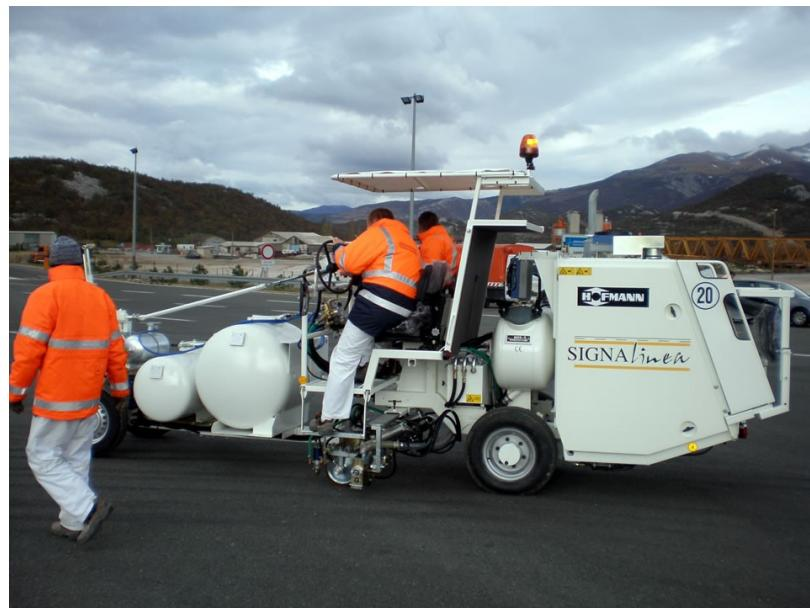
Slika 4. Stroj većeg kapaciteta za izvođenje bojanih oznaka na kolniku
