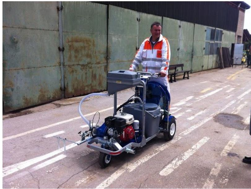
Slika 3. Stroj manjeg kapaciteta za izvođenje bojanih oznaka na kolniku
