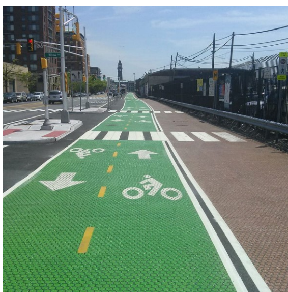
Slika 9. Zelene oznake za obilježavanje površina namijenjenih kretanju biciklista Izvor: [22]
