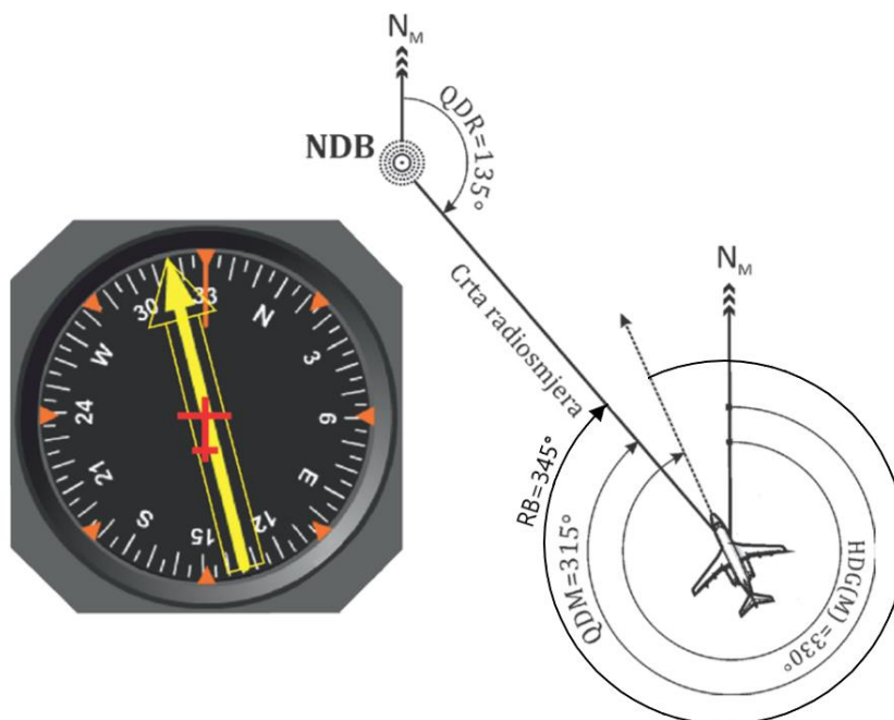
Slika 3 Magnetski kurs, QDM, QDR i stranski kut, [2]
