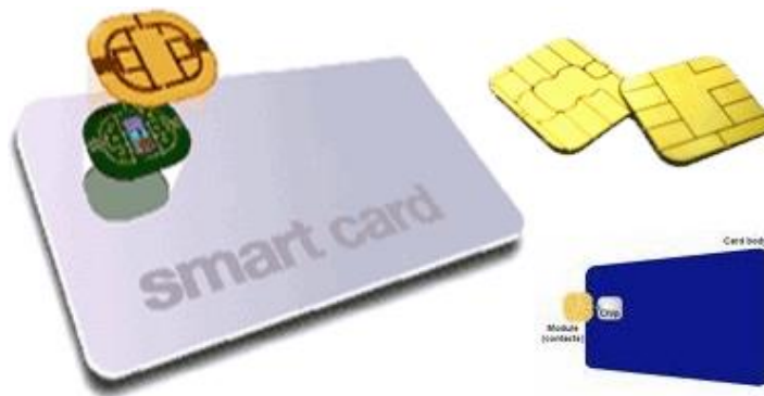
Slika 3.1. Presjek pametne kartice, [49].
