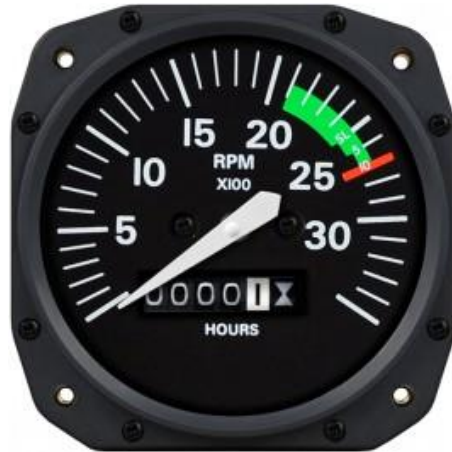
Slika 7. Prikaznik tahometra sa karakterističnim postavkama snage
