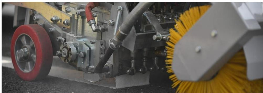
Slika 11. Prikaz izljevanja vruće termoplastike na kolnik pomoću Extrudera
