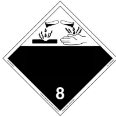
Slika 9. Oznaka 8.klase - Korozivne (nagrizajuće) tvari
