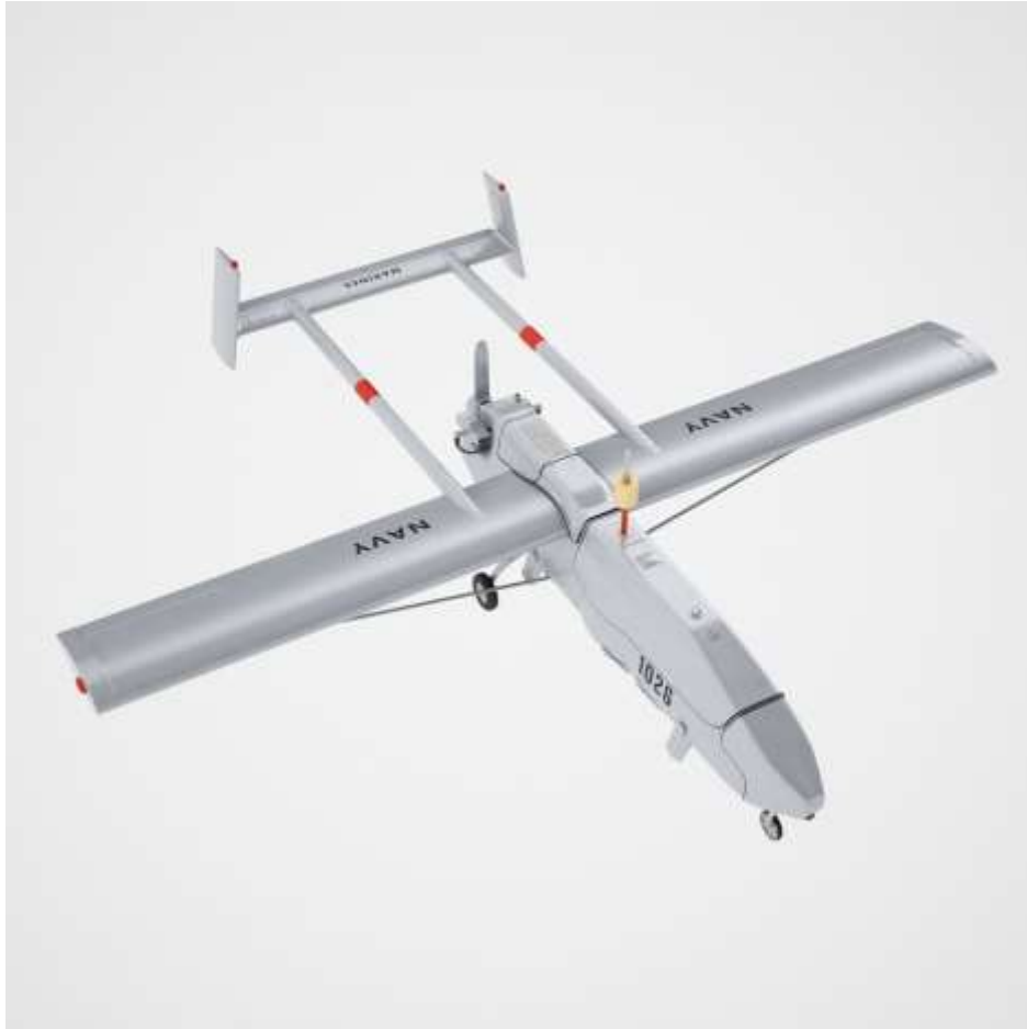
Slika 5. 3D prikaz bespilotne letjelice RQ-2 Pioneer, [11].
