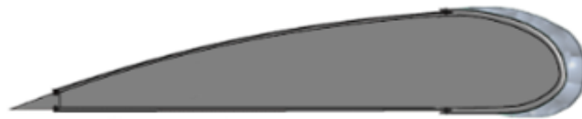
Slika 2.6. Mješoviti led na aeroprofilu [5]
