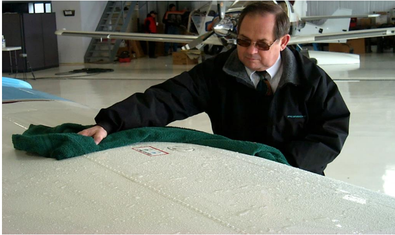
Slika 4.5. Odleđivanje zrakoplova u grijanom hangaru [20]
