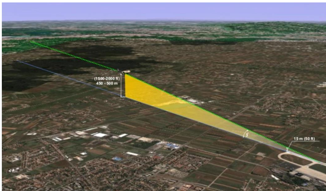
Slika 17. Standardni postupak slijetanja na Zračnoj luci Franjo Tuđman. [2]
