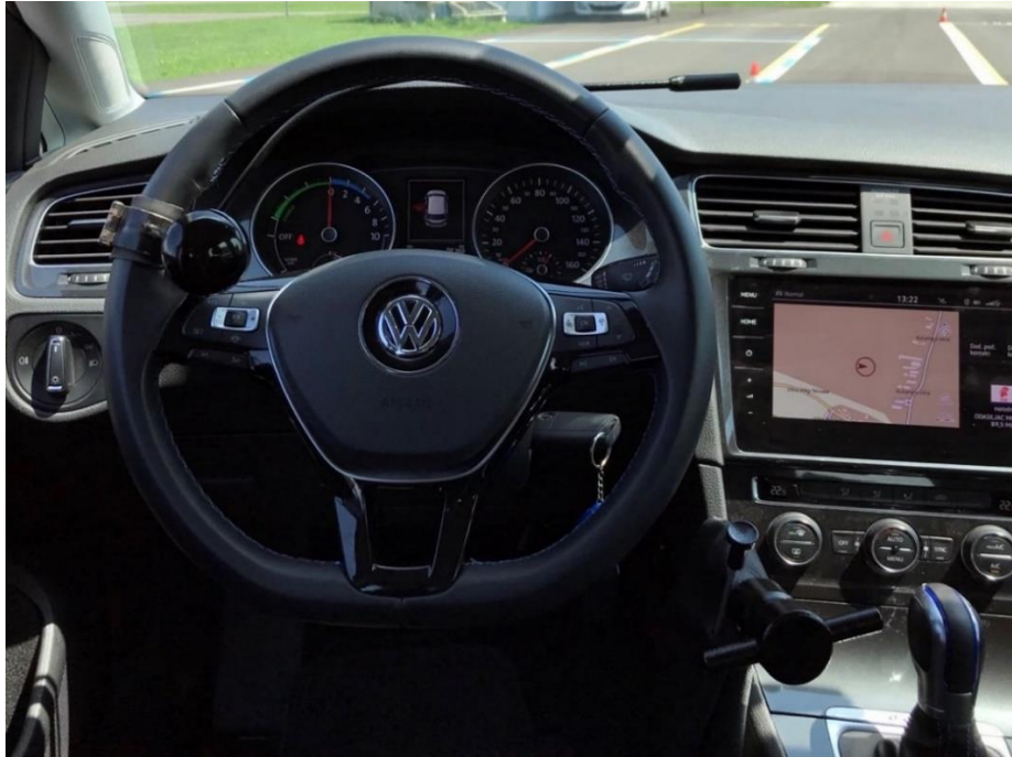
Slika 11. Vozilo s kuglom i ručicom za kontrolu gasa i kočnice
