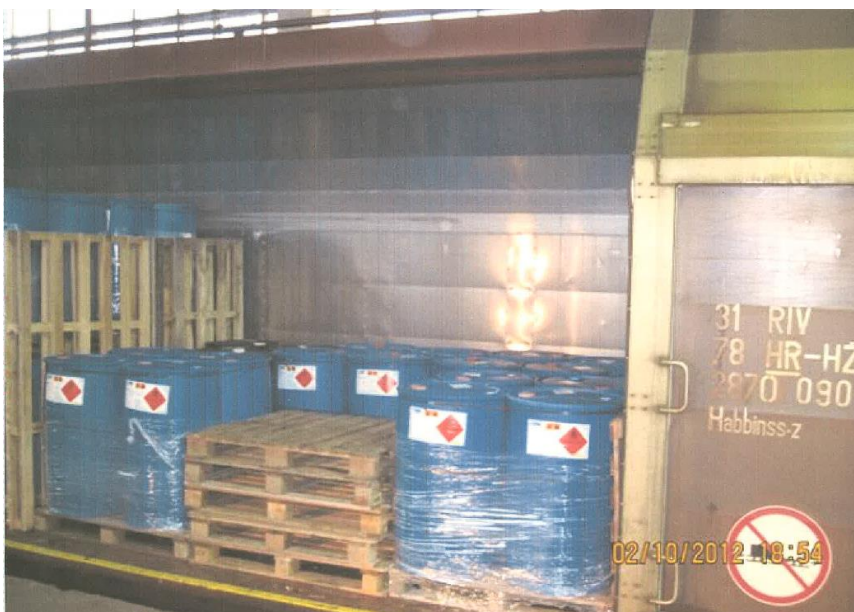
Slika 4. Način postavljanja paleta između bačvi u teretnom prostoru vagona
