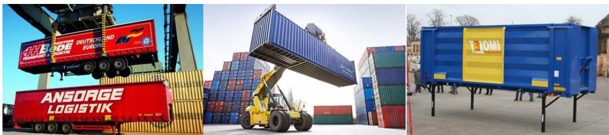
Slika 2 Intermodalne prijevozne jedinice (ITU) [3]
