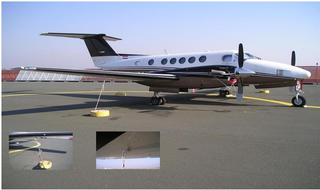
Slika 5. Sidrenje zrakoplova općeg zrakoplovstva [8]
