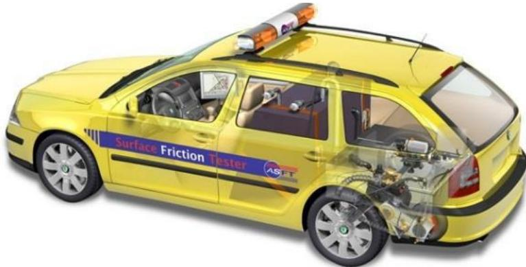
Slika 8. Vozilo opremljeno za mjerjenje koeficijenta trenja [13]
