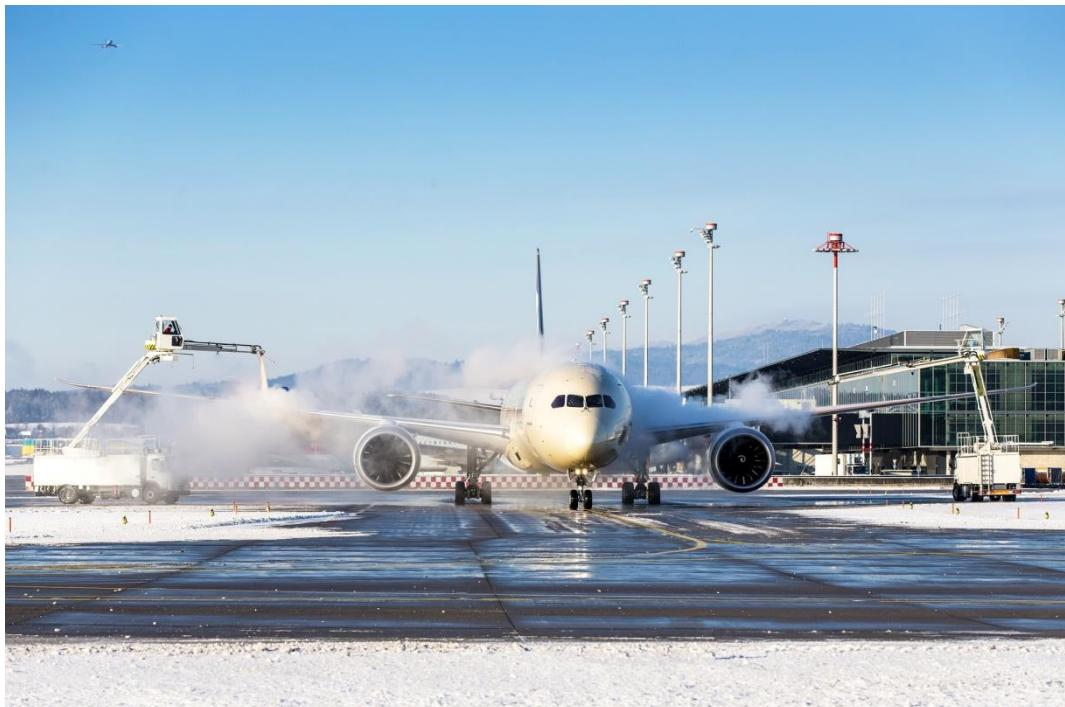
Slika 11. Odleđivanje zrakoplova [22]
