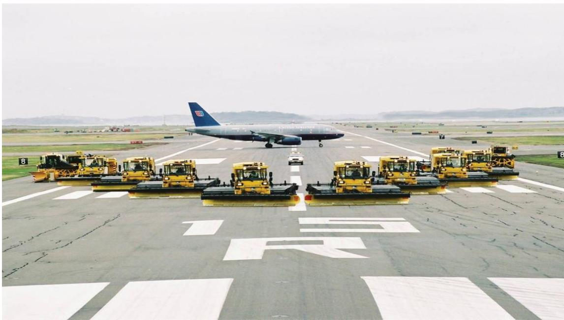
Slika 9. Postupak mehaničkog čišćenja konstruktivnih kolničkih površina [21]
