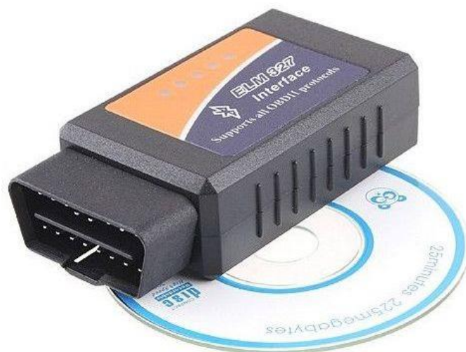
Slika 1. Prikaz OBD-II ELM327 adaptera
