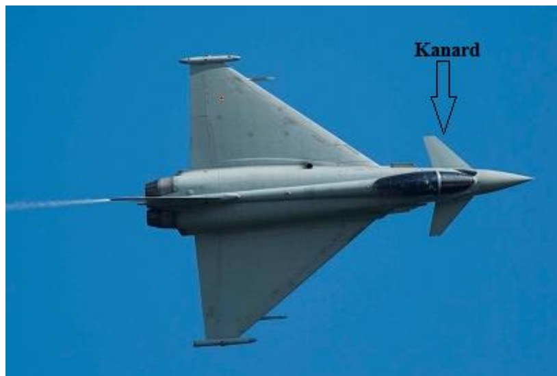
Slika 23.: Prikaz kanarda na borbenom zrakoplovu Eurofighter Typhoon
