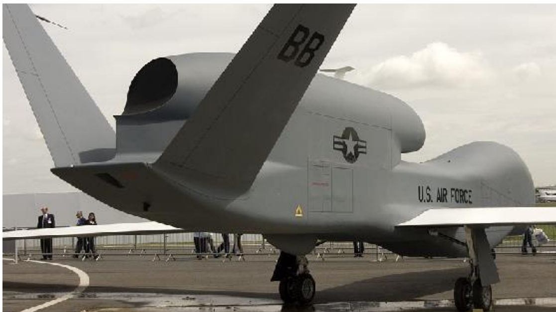
Slika 24.: Prikaz V-repa na zrakoplovu Northrop Grumman RQ-4 Global Hawk
