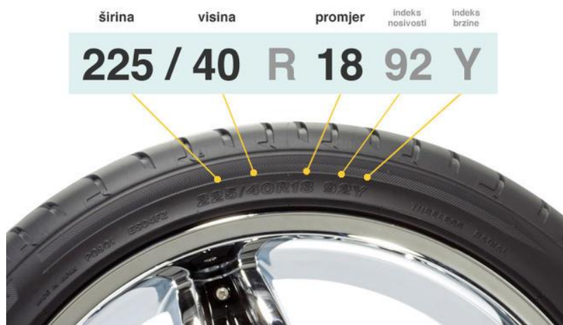
Slika 1. Osnovne veličine pneumatika
