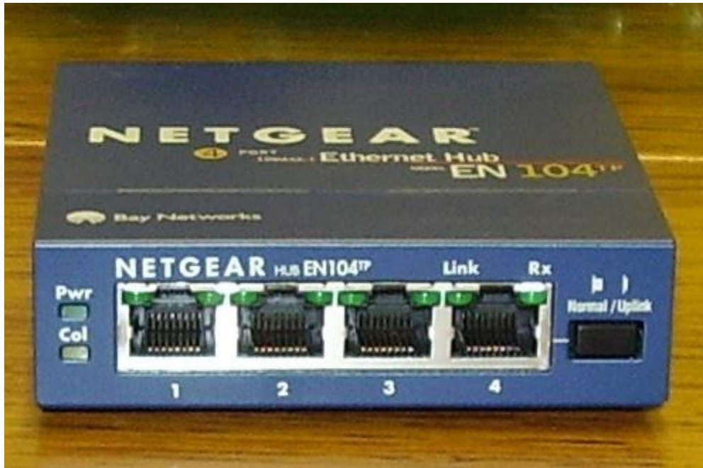
Slika 10 Ethernet hub sa četiri porta [9]
