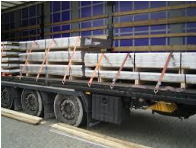
Slika 5.: Osigurane ploče na poluprikolici nakon utovara, [14]
