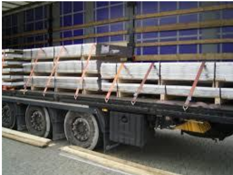
Slika 5.: Osigurane ploče na poluprikolici nakon utovara, [14]
