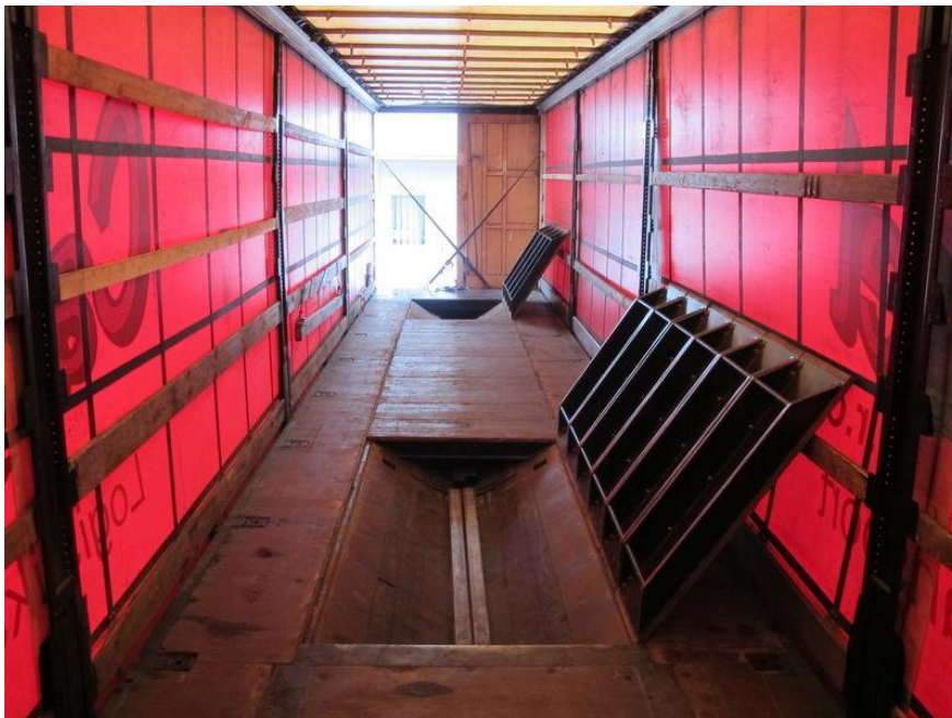
Slika 8. Unutarnji izgled prikolice za prijevoz tereta valjkastog oblika
