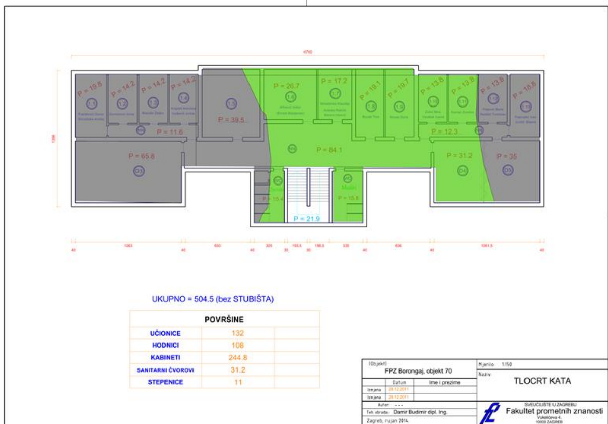
Slika 23. Preklapanja signala na prvom katu objekta 70
