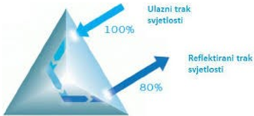
Slika 9. Prikaz prizmatične retrorefleksije
