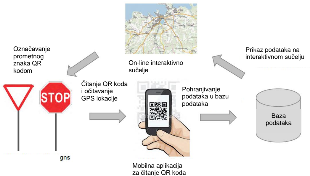
Slika 7. Primjer održavanje baze podataka prometnih znakova primjenom QR kodova u Estoniji
