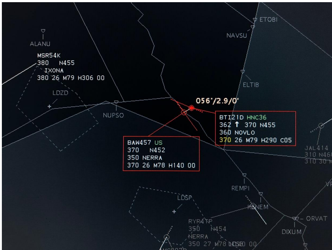
Slika 12 Prikaz simulacije aktiviranog STCA upozorenja
