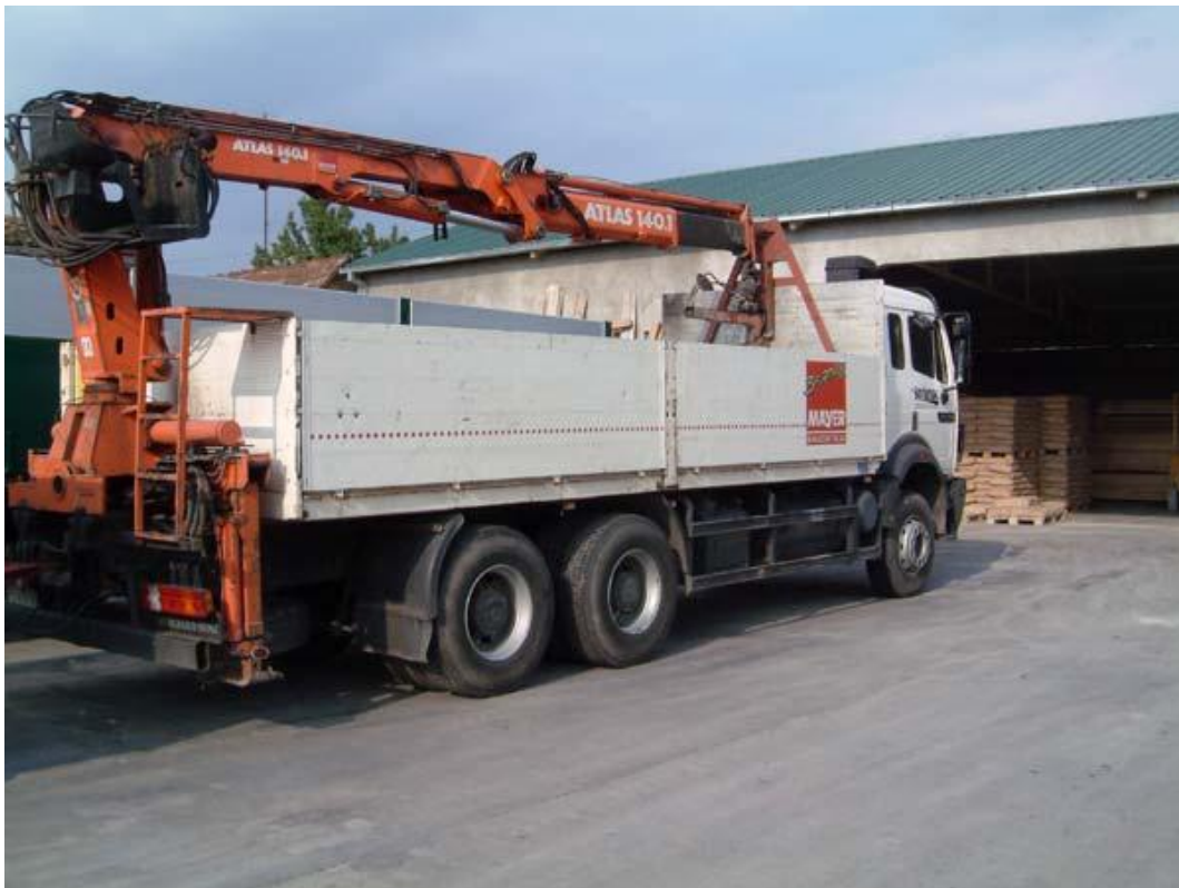
Slika 11. Kran na kamionu
